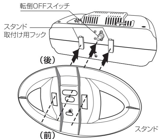
③ スタンドを本体底面に密着させた状態でスタンドの矢印表示の方向にスタンドをカチッと音がして止まるまでスライドさせます。
