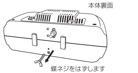
② 図のように本対底面にスタンドの前後を確認して、スタンド取付け用フックと転倒OFFスイッチをスタンドの穴に合わせて、スタンドを本体にはめ込みます。
