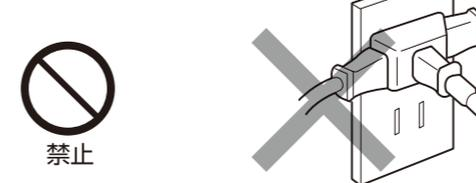
差し込みプラグを抜くときは、電源コードを引っばらずにプラグを持って引き抜く。
