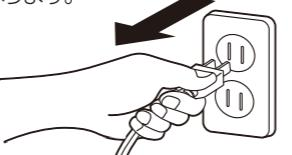
差込みプラグを抜くときは、電源コードを引っぱらずにプラグを持って引き抜く。
