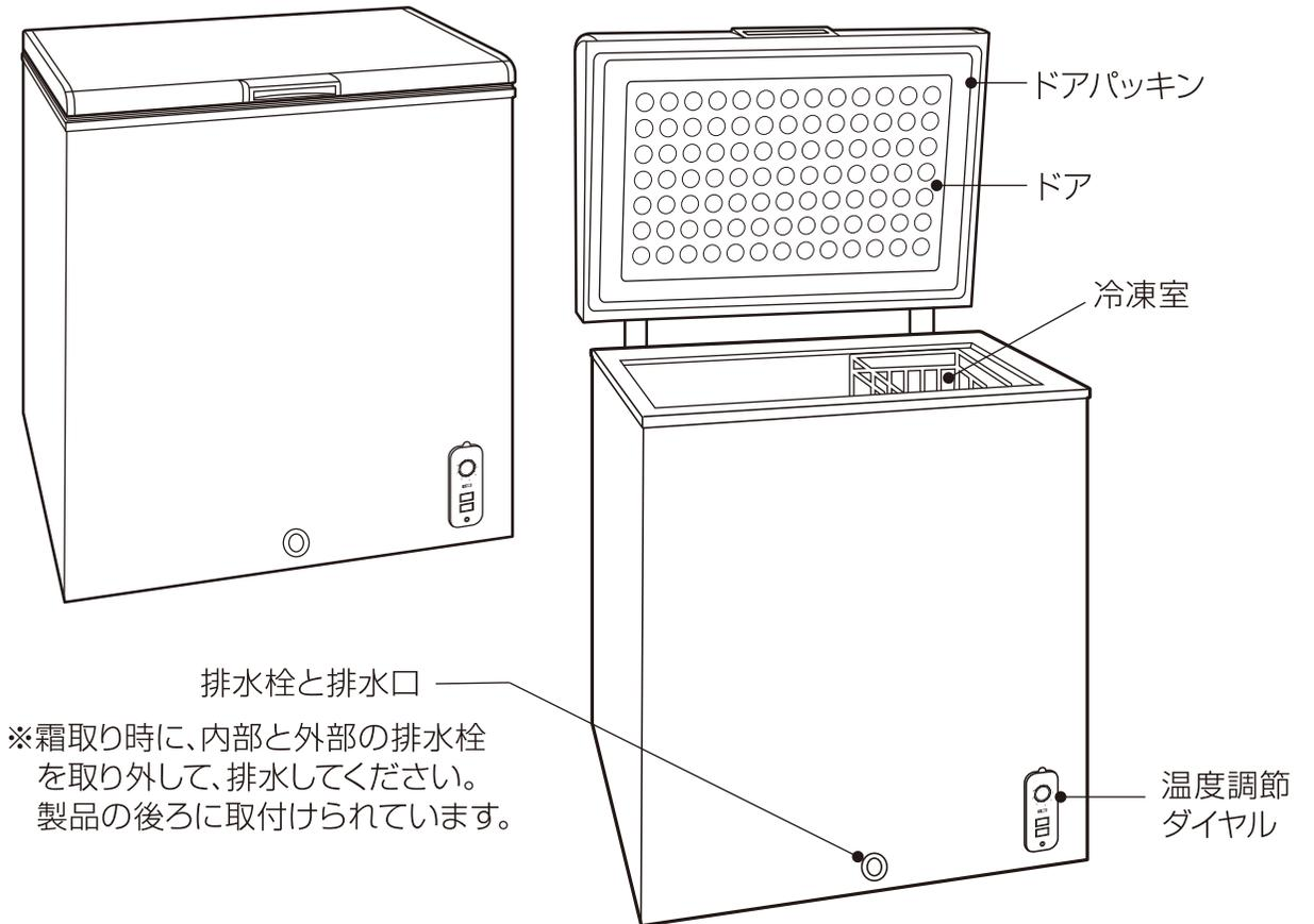
※霜取り時に、内部と外部の排水栓を取り外して、排水してください。製品の後ろに取付けられています。
