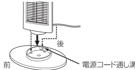
② 本体を台の上などにねかして、はずした蝶ネジでスタンド底面から本体に、確実に止めます。
