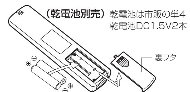
※電池の取り扱いを誤ると、破裂や液漏れなどによりけがや故障の原因になります。
