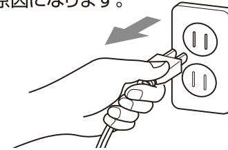
差込みプラグを抜くときは、電源コードを引っぱらずにプラグを持って引き抜く。
