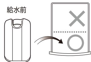
2.凍らせておいた冷却タンクは給水タンク内の手前に入れた後、給水してください。(上図)
