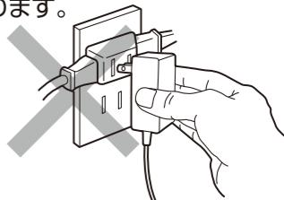
コンセントの差し込みがゆるいときは、使用しない。付属のACアダプター以外を使用しない。また、ACコード・ACアダプターが傷んだときは使用しない。
