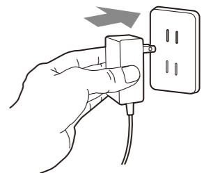
差込みプラグをコンセントに差し込んだ際に、電子音がなり、ディスプレイ及びすべてのランプが全灯します。その後ランプが消灯し、ディスプレイに現在の室温が表示されます。
