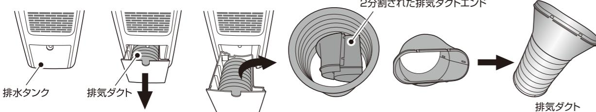
排気ダクト部分を出す場合は、排水タンクを引き出し、排気ダクトを取り出します。
