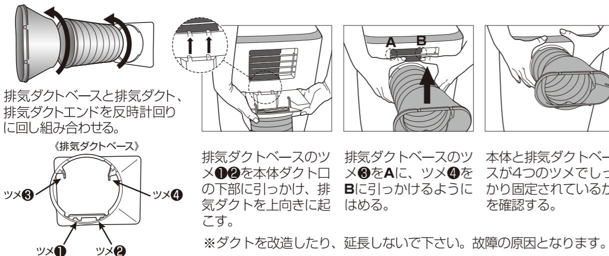
排気ダクトベースと排気ダクト、排気ダクトエンドを反時計回りに回し組み合わせる。
