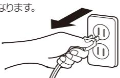
差込みプラグを抜くときは、電源コードを引っぱらずにプラグを持って引き抜く。
