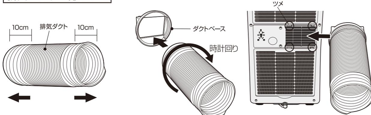
排気ダクトの両側10cm程度を引き伸ばし、長さを調整します。
