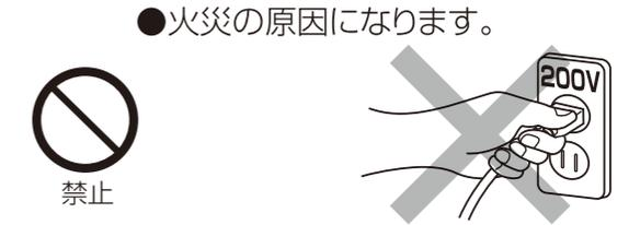
運転中に差し込みプラグを抜いて運転を停止させない。
