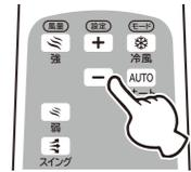
冷風モード時に、ボタンを押すたびに設定温度を1℃下げます(~16℃まで)。タイマー設定時に、ボタンを押すたびに1時間カウントダウンします(00~24時間)。
