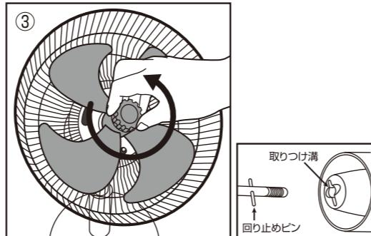
羽根の溝とモーター軸の回り止めピンが合うようにして羽根を差し込みます。スピナーナーを反時計回りにゆるまないようにしっかりと締め付けてください。
