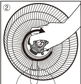
後ろガード締め付けナットを時計回りにゆるまないようにしっかりと締め付けしてください。
