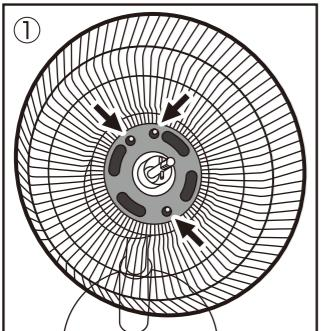
本体の突起と後ろガードの穴の位置を合わせて後ろガードをはめます。
