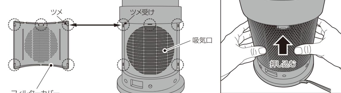
フィルター枠のツメの位置を確認し、本体のツメ受け側に合わせ、押し込むように取り付けます。
