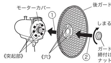
ガード締付けナットとスピンナーは、使用中にゆるまないようにしっかりと締付けてください。
