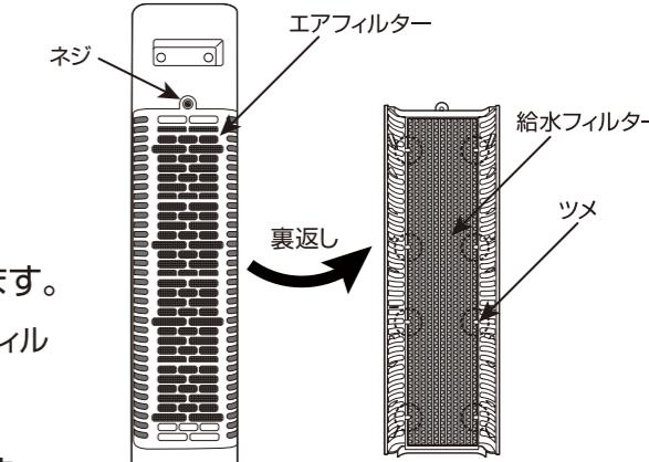
2. エアフィルター・吸水フィルターを外します。
