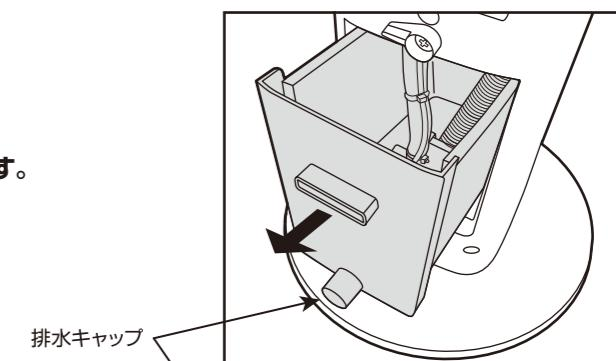
4. 排水キャップを取り外して、排水します。
