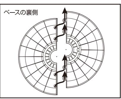
4. ベース固定ナットを時計回りに回して、ベースと本体を固定します。
