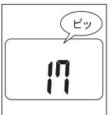
2.ピッと音がし、表示部にセンサー使用回数が表示される。
