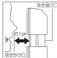
5.STARTが表示されカウントダウン中に吹きかけ口から1cm程度離して約4～5秒間息をフッと吹きかける。
