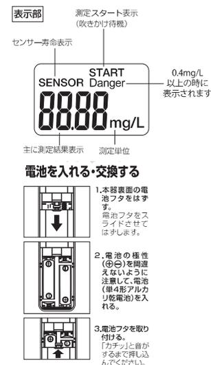
電池が消耗すると表示部に「Lo」が表示されます。速やかに新しい単4形アルカリ乾電池2本と交換してください。必ず2本を同時に交換してください。
