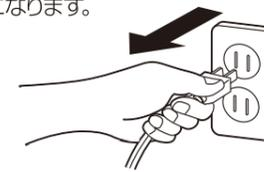
差込みプラグを抜くときは、電源コードを引っ張らずにプラグを持って引き抜く。
